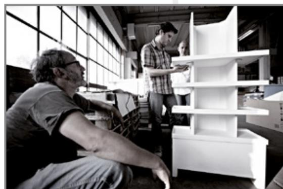
Il nostro team di progettisti si avvale dei più moderni sistemi di disegno e prototipazione. Presentiamo in anteprima le nostre proposte tramite la realizzazione di rendering 3D, campionature con i materiali di produzione, con i quali eseguiamo anche le necessarie prove di carico con i prodotti del cliente, crash test e shipping test, al fine di verificarne l'efficienza strutturale.
